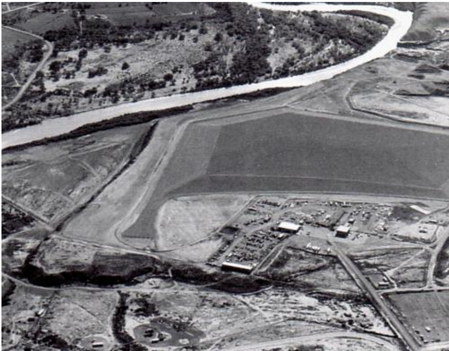
Oben und seitlich zum Teil versiegelte Abraumhalde, aber trotz Flussnähe ohne Sicherung zum Grundwasser. Aus: Internet
